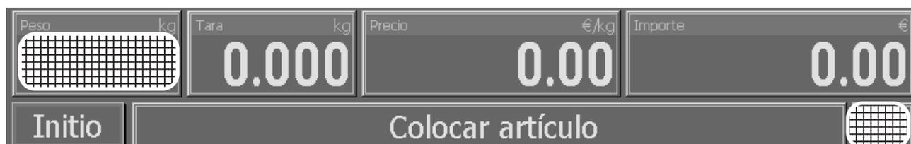
La balanza tiene un dispositivo de puesta a cero automático, que compensa pequeñas acumulaciones de producto sobre la balanza. El dispositivo de puesta a cero queda desconectado cuando se realiza una tara. Tras eliminar los posibles depósitos de suciedad, y con la balanza conectada, en el display aparece o bien
